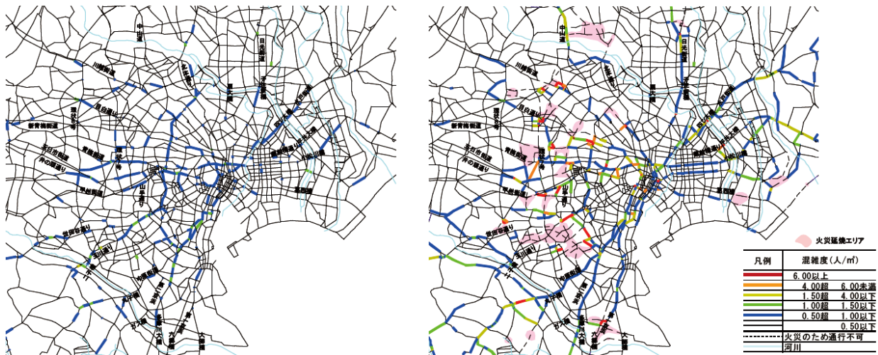
図7 路上混雑度のシミュレーション結果（発災から4時間後）
