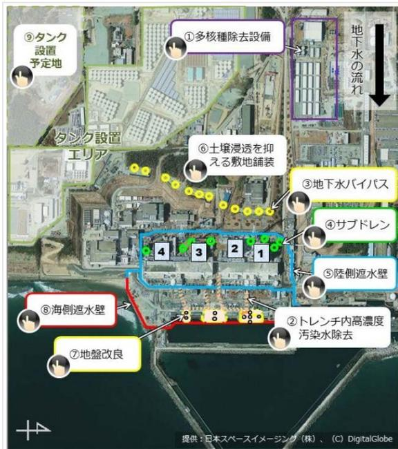
福島第一原子力発電所の汚染水対策
