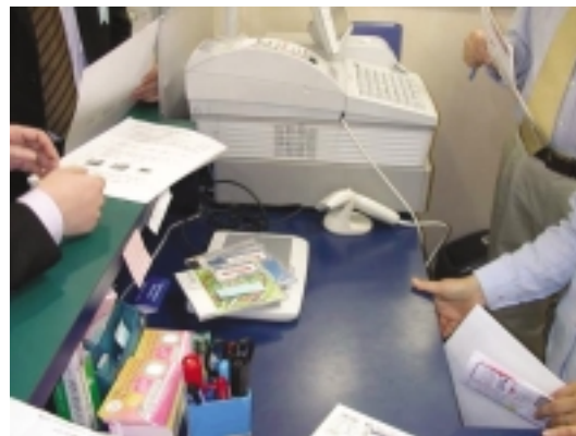
商品を電子タグリーダーで読み取っているところ（中央部分が電子タグリーダー）
